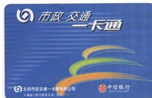
接触式IC卡的多个金属触点为卡芯片与外界的信息传输媒介，成本低，实施相对简便；非接触式IC卡则不用触点，而是借助无线收发传送信息，因此在前者难以胜任的交通运输等诸多场合有较多应用。
